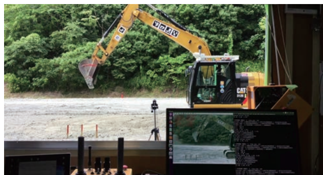
▲ 深層学習を用いたバックホーの自動操縦の試み
